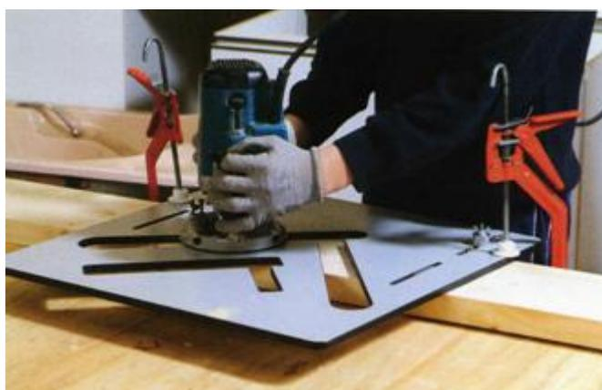
階段組み込み加工治具を用いたルーター加工
