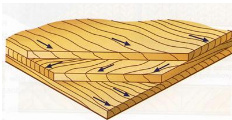
図9. 26 木目の方向を示した合板の断面
