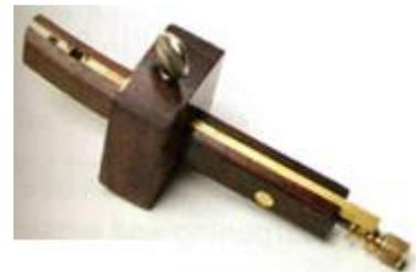
図8. 1 鑿 (のみ) の刃の幅に合わせて、ほぞ穴罫引きの設定
