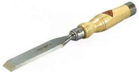
柄は他ののみより長く、槌で叩けるようデザインされた広く曲がった頭（かしら）を持っている。それはしばしば金属リングで包まれ、槌の打撃を吸収するために刃の肩と柄の間に、革の座金が挿入されている。柄は単純な挟みこみやソケットで保持されている。
